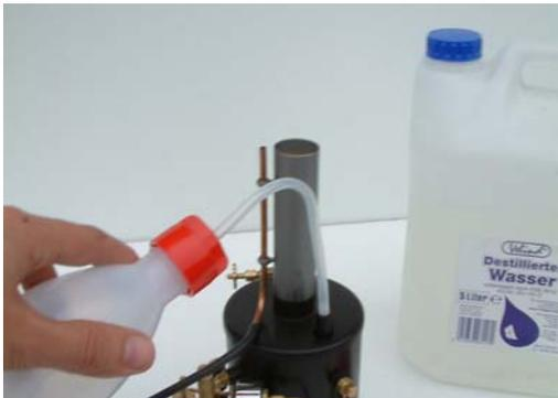
Um Dampf zu erzeugen wird Wasser benötigt. Damit dieses den Kessel nicht verkalkt verwendet man am einfachsten destilliertes Wasser, dem man allerdings 3-5% Leitungswasser zugeben sollte, um dem Destillat die Aggressivität zu nehmen. Auch durch einen Kaffeefilter gefiltertes Regenwasser, Wasser aus einem Luftentfeuchter oder aus einem Kondensat-Wäschetrockner eignet sich.
