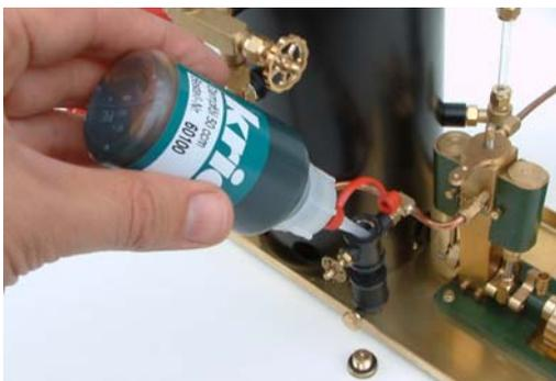
Nicht nach der Fahrt sondern vor der nächsten Fahrt wird das Kondenswasser am Öler unten abgelassen. Legen Sie ein Papiertuch unter den Öler und öffnen Sie die Einfüllschraube oben und die untere Schraube des Ölers. Es werden nur ein paar Tropfen Kondensat austreten. Bei offener Ablassschraube füllen Sie nun von oben das Heißdampföl (Bestell-Nr. 60100).
