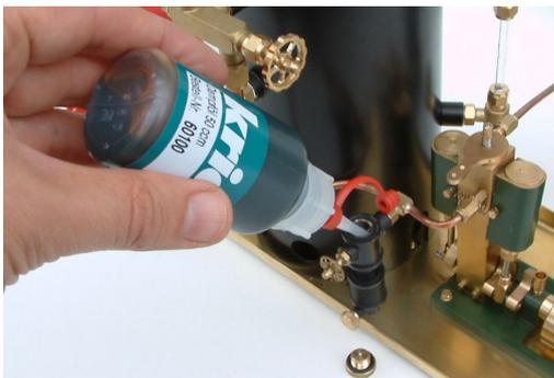
L'eau de condensation est vidangée sur le huileur, non pas après la navigation, mais avant la prochaine navigation. Posez un mouchoir papier sous le huileur et ouvrez les vis de remplissage supérieure et inférieure. Quelques gouttes de condensat s'échapperont. La vis de vidange étant ouverte, remplissez l'huile de vapeur (Réf. N° 60100) par le haut.
